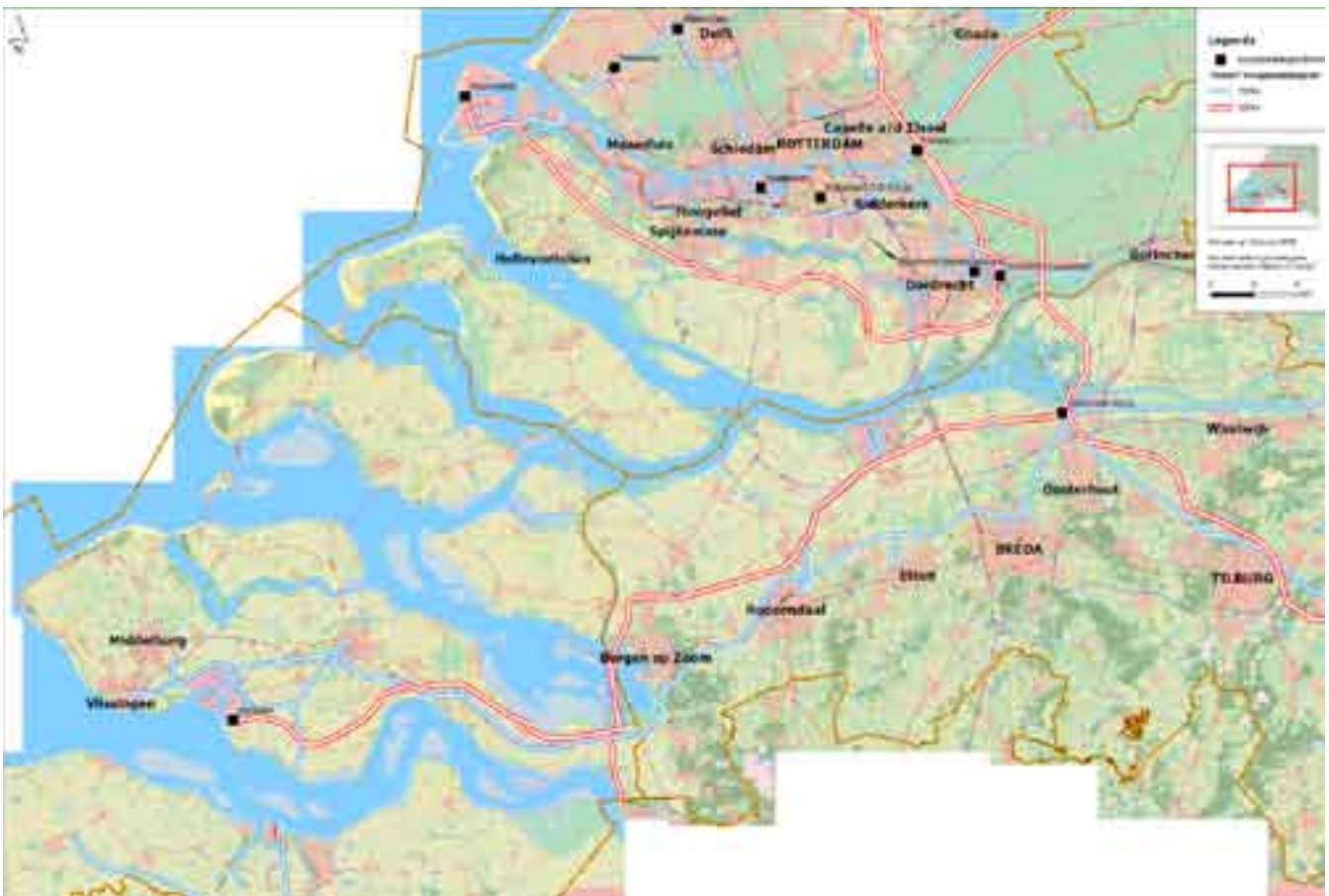
Figuur 1.1 Overzichtskaart Zuidwest-Nederland met daarin aangegeven de bestaande 150 kV (blauwe lijn) en 380 kV (rode lijn) hoogspanningsverbindingen en stations (blokjes).
